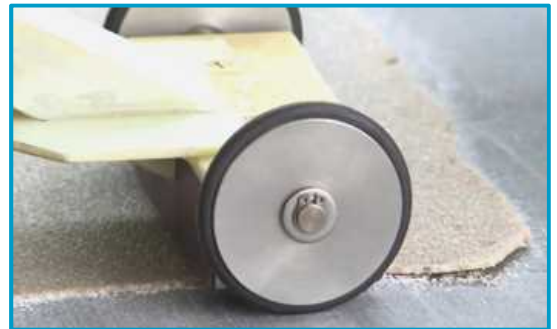
被膜の上から誘導加熱ヘッドで鋼板を加熱
