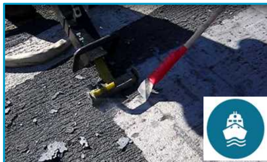
船舶デッキ：防滑コーティング
