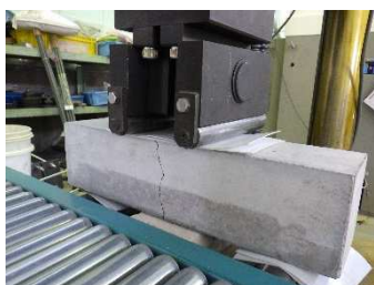
● ひび割れ含浸試験
