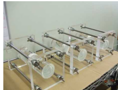
遮塩性試験状況
