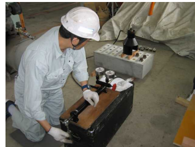
コンクリートとの付着強さ試験状況
