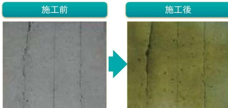
意図的にひび割れを発生させたコンクリート平板上の可視性を確認しました。
