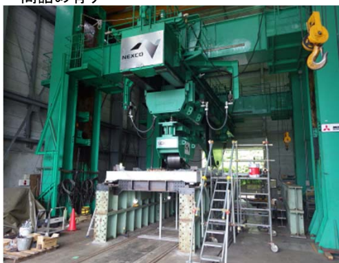
施工技術総合研究所での輪荷重走行試験
