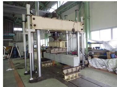
梁部材の曲げ試験
