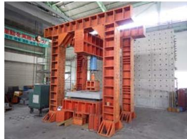
版部材の押し抜きせん断試験
