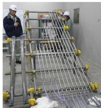
内径 3mm の傾斜管試験(右から3本ずつ長さ 3m、2m、1m)
