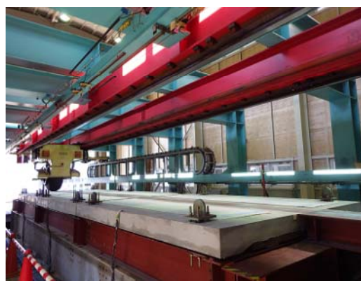
プレキャスト床版の輪荷重疲労走行試験
