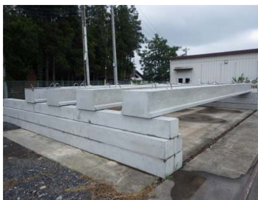
高炉スラグ細骨材のアルカリ骨材抑制効果確認試験
