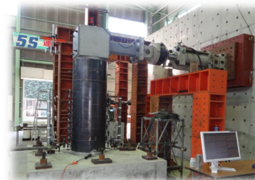
耐震補強工法の実験
